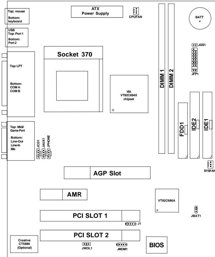
**MS-6323 Micro ATX VA6 Mainboard**
