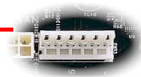
Extra-Netzanschluss für 5V/3.3V
