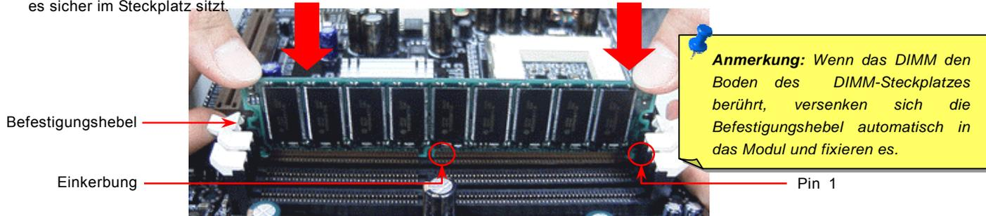
3. Wiederholen Sie den zweiten Schritt zur Installation weiterer DIMMs.
